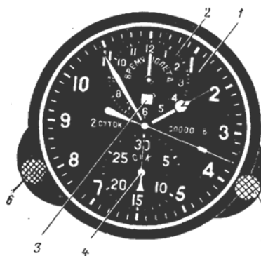
Рис. 21 Бортовые часы АЧС-1М:
